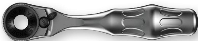
**Anwendung:** Geeignet für die Aufnahme von Bits mit 1/4"-Außensechskantantrieb nach DIN ISO 1173-C 6,3 und E 6,3 und Wera Anschluss-Reihen 1 und 4; über Adaptierung mit Wera Adapter 870/1 ist auch der Einsatz von 1/4"- Nüssen möglich
